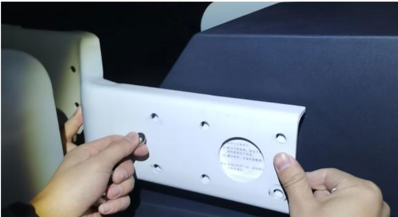
**步骤3** 安装杆把，先安装对角的两个螺丝，然后**装上全部螺丝**，**但不要拧紧**，以便于下一步进行闸杆安装
