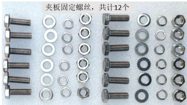
先安装对角的两个螺丝，然后**安装全部螺丝，但不要拧紧**
