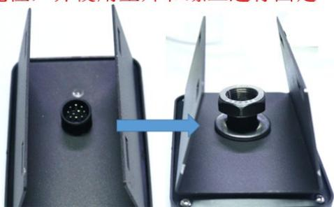
步骤3: 将线束端插入雷达底部螺栓
