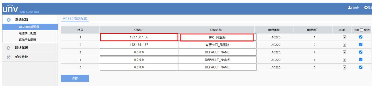
4.AC220V 端子支持一对多（一个电源输出端口给多台设备供电），电源配置界面最大支持一个 220V 端口对应 3 条设备信息。点击[系统配置>AC220 电源配置]界面“加减”一栏中的加号，可为当前端口添加一条设备信息。AC220V 电源信息配置最大可配置 15 条设备信息，如下图所示。
