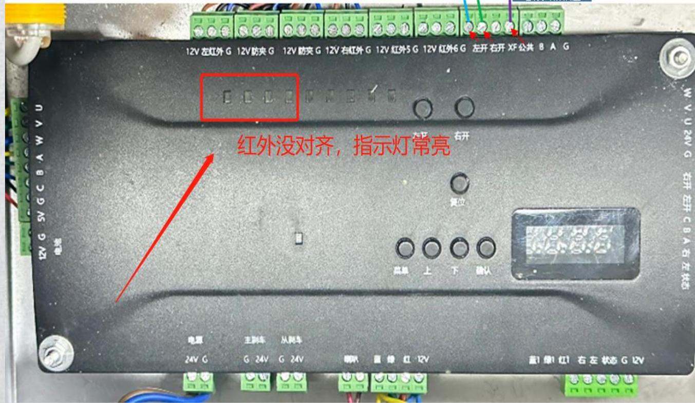
图1 主机红外指示灯示例
