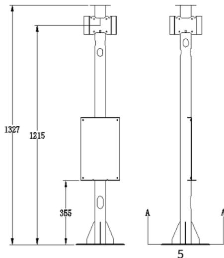
图7-2 地桩施工 (单位: mm)
